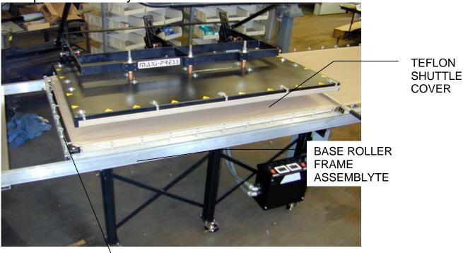
LEFT SIDE OF MAIN TEFLON SHUTTLE FRAME PICTURE OF THE COMPLETED BASE ROLLER FRAME ASSEMBLY
