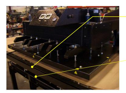
FRONT BASE TUBE ON ROLLER FRAME ASSEMBLY
